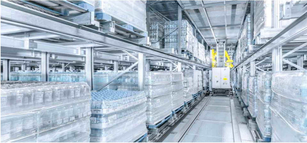
<그림1> 자동화 물류센터의 적하 시스템
